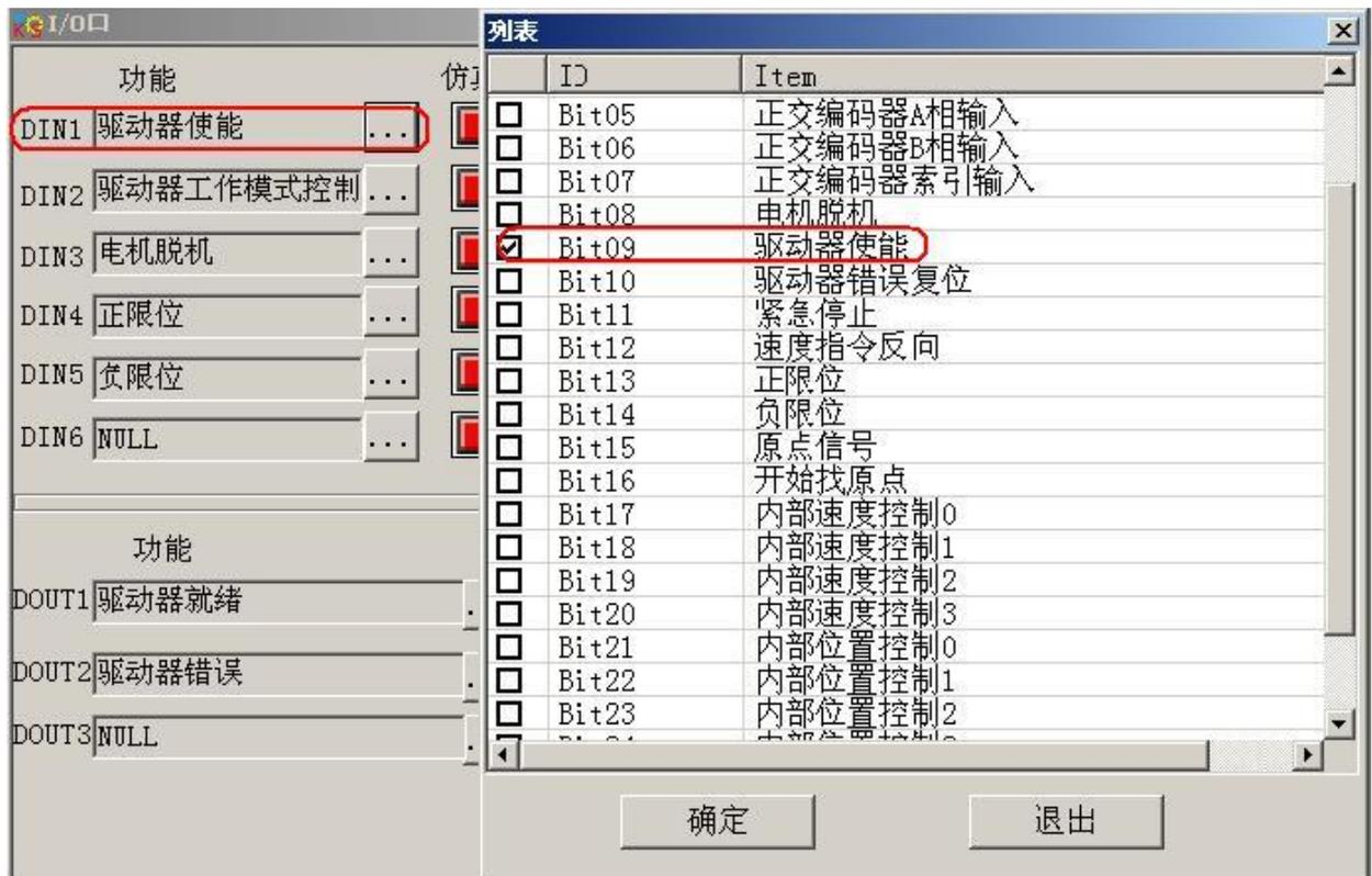
图 6-3 调试软件设置 I/O 功能示意图
