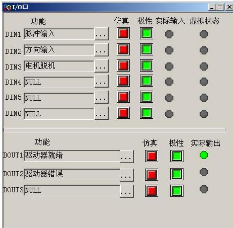
在本菜单可以对驱动器 I/O 进行功能定义，极性设置，具体操作步骤可参考例子说明。还可以监控 I/O 实际输入输出状态，模拟仿真等功能。上图所示是默认 I/O 设置。
