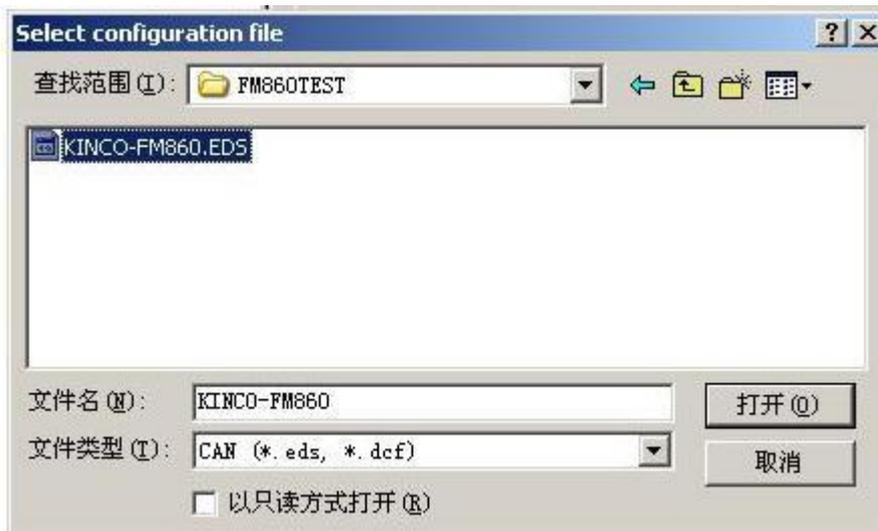
(5) F1 有两个 CAN 口，都可以做主站，设置主站的站号、波特率。如果需要同步报文，请先激活“active”，然后在“Com. Cycle period”里设置同步报文的传输周期和 COB-ID；
