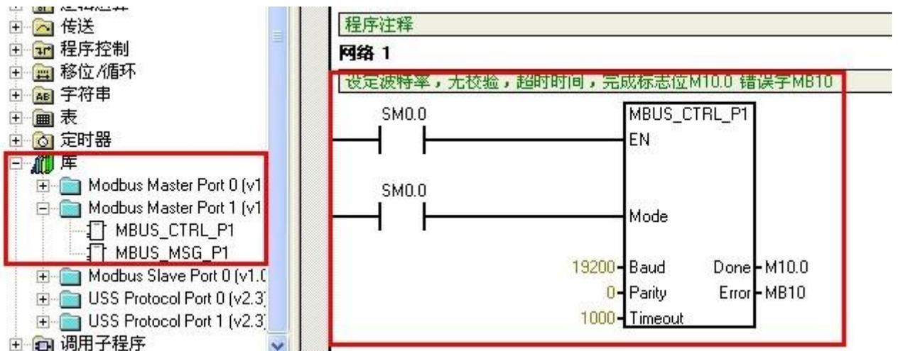
图 9-11 S7-200 PLC 通讯参数
