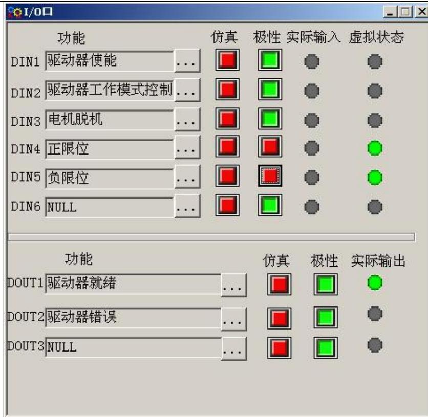
图 6-2 kincostep 调试软件中数字 I/O 示意图
