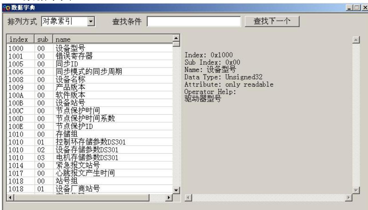
在本菜单可以查询到所有 CM 驱动器内部对象地址及详细含义。如上图所示，左边显示的对象符合 CANopen 定义的 INDEX, SUBINDEX 地址及其命名，右边有详细参数含义以及状态属性，数据长度等信息！
